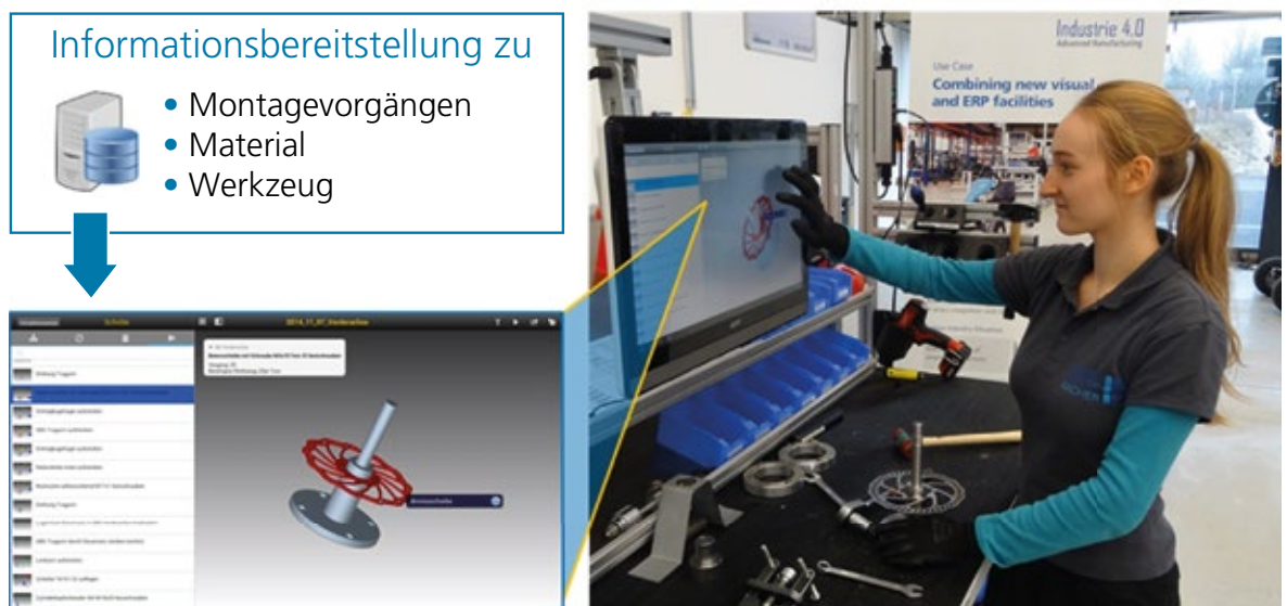
Abb. 5: Intuitive Darstellung von Montageschritten durch 3D-Montageanleitung
