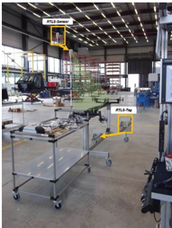
Abb. 3: Präzise Echtzeitverfolgung durch RTLS
