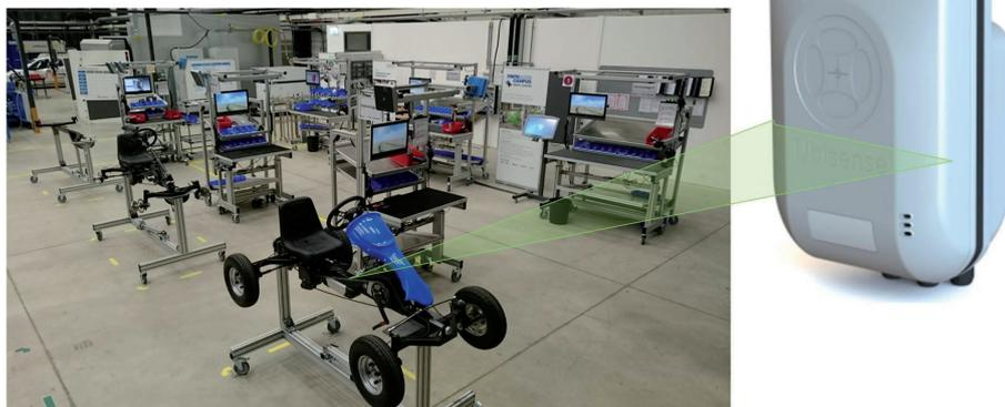
**Bild 2.** Die echtzeit-funkbasierte Ortungslösung „Real-Time-Location-System“ (RTLS) sorgt für mehr Überblick in der Montage.
